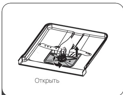
1 Удерживая фильтр грубой очистки, поверните его против часовой стрелки, чтобы разблокировать. Поднимите фильтр вверх и выньте его из посудомоечной машины.
