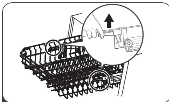
2 Чтобы опустить верхнюю корзину, поднимите регулировочные ручки с каждой стороны, чтобы освободить корзину и опустить ее в нижнее положение.
