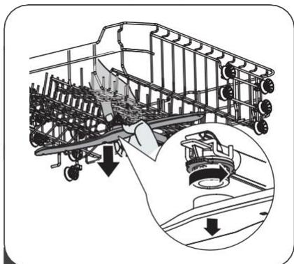
1 Чтобы снять верхний распылитель, удерживайте гайку в центре неподвижно и поверните его против часовой стрелки, чтобы снять.
