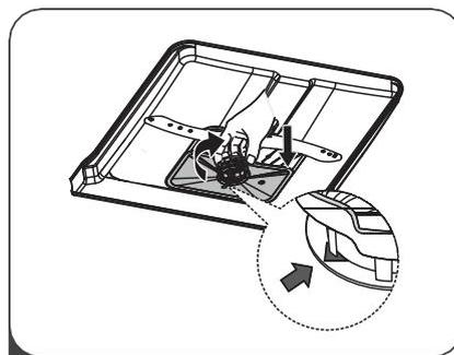
4 Соберите фильтры в порядке, обратном демонтажу, установите фильтрующий элемент и поверните его по часовой стрелке до фиксации.
