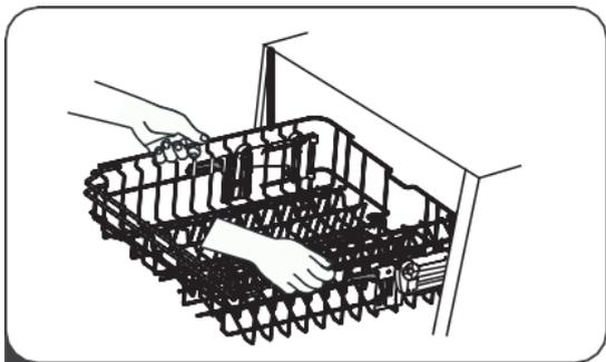
1 Чтобы поднять верхнюю корзину, просто приподнимите ее по центру с каждой стороны, пока она не зафиксируется в верхнем положении. Поднимать рукоятку регулятора не обязательно.
